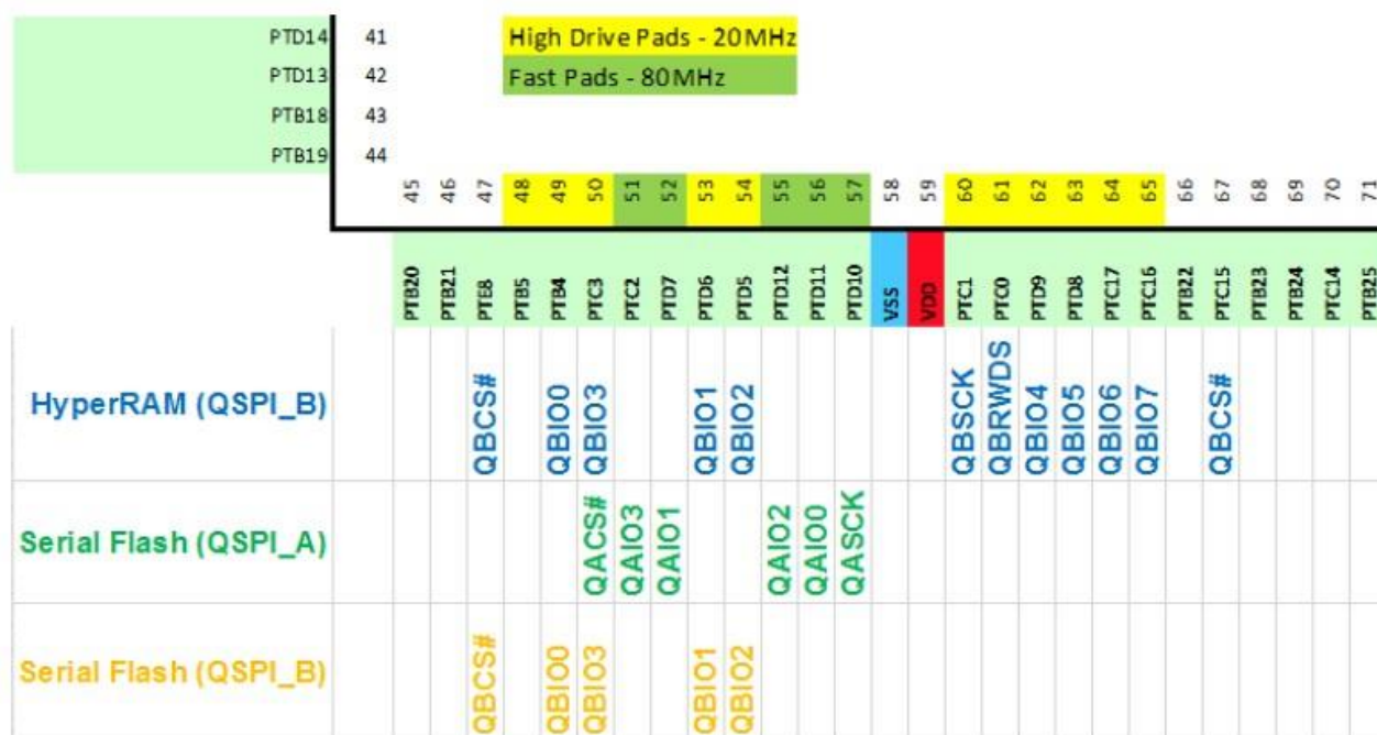
图 2. S32K148 引脚分配：QuadSPI 模块 A 面和 B 面
